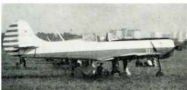
In der Seitenansicht unterscheidet sich die Jak-18 PM von ihrem Vorgängermuster lediglich durch die um etwa 1,5 m nach hinten verlegte Kabine. Unter der Motorhaube stecken 300 PS!
