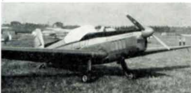
Der polnische „Beskid I“ ist nichts anderes als eine Modifikation des Z-126 „Trenner“ mit 160-PS-Triebwerk Walter „Minor 6-III“, einem um 27 cm verkürzten Rumpf und veränderten Tragflügeln
