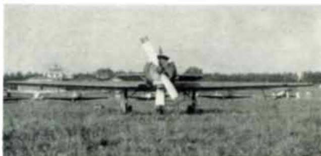
Das leistungsstärkste Flugzeug der diesjährigen Weltmeisterschaft war zweifellos die sowjetische Jak-18 PM. Die Vorderansicht zeigt deutlich den Tragflügel mit der auf 2° verringerten V-Stellung
