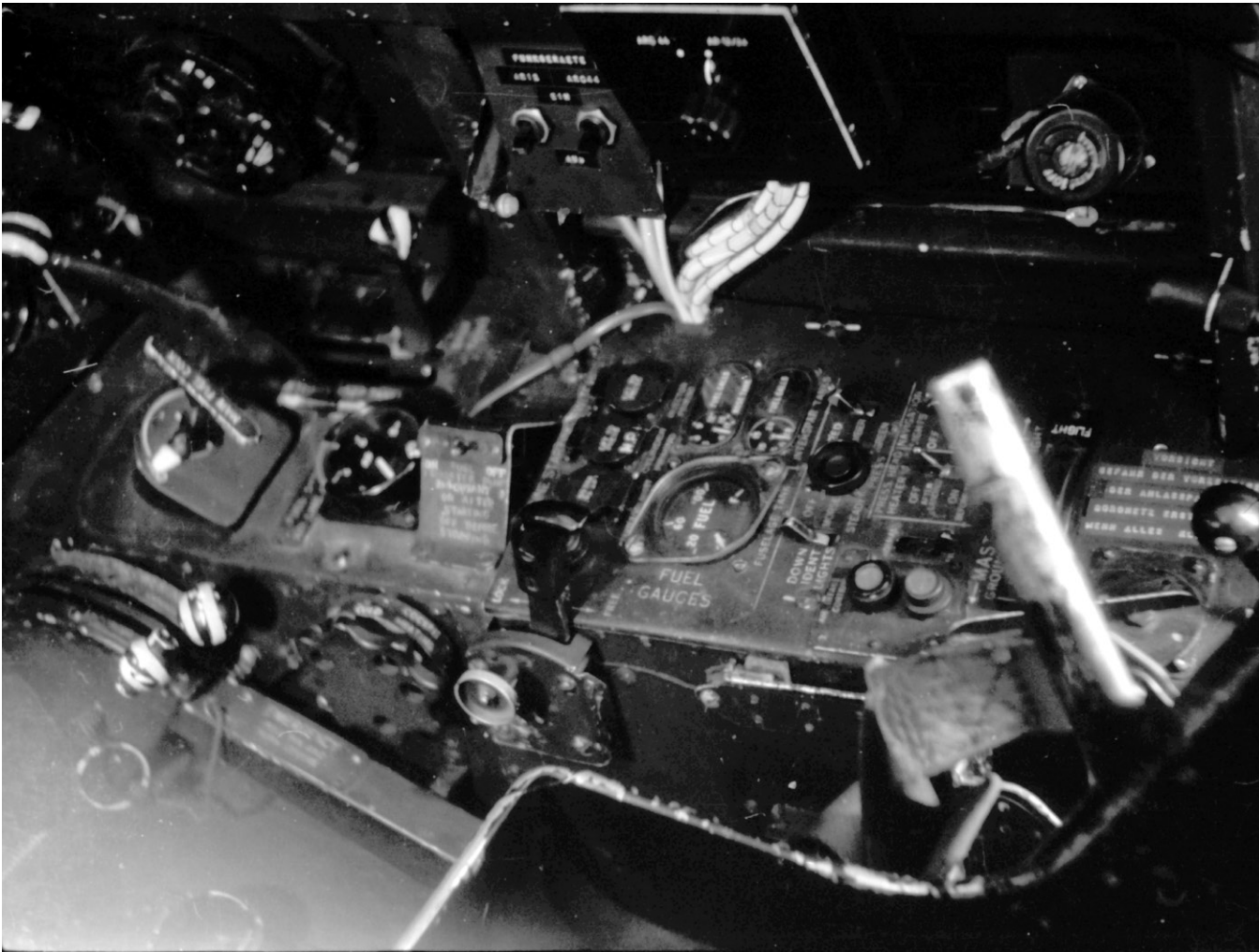
Die rechte Gerätebank mit der Treibstoffanzeige.
