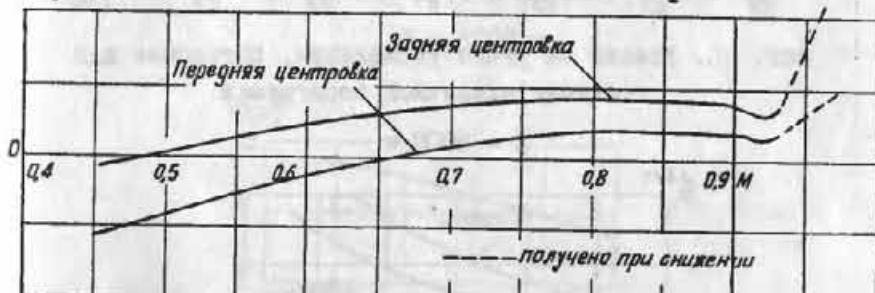
Фиг. 28. Углы отклонения руля высоты в горизонтальном полете.  $H = 5000 \text{ м}; n = II560 \text{ об/мин}; \tau_{tr} = 0^\circ$
